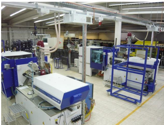
Zwei 180-t-Maschinen im Einsatz
